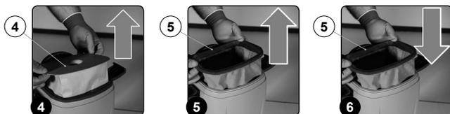
8. Insérer le sac de ramassage dans le bidon de ramassage (4) (Fig.7)
